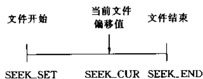
图 15.1 lseek() 系统调用的偏移值的三种基本位置
